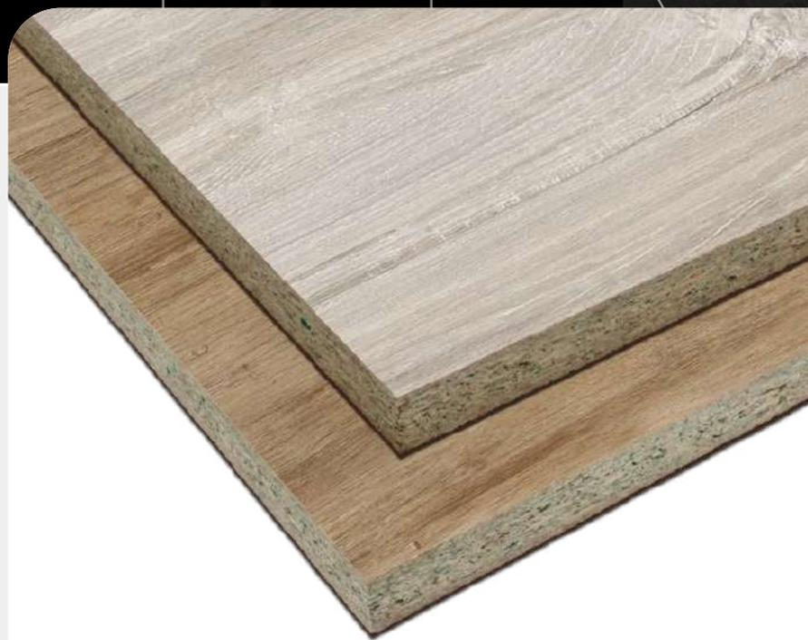
Es un tablero de partículas de madera unidas entre sí mediante un adhesivo de melamina urea formaldehído y recubierto por ambas caras con láminas decorativas de variados diseños, impregnadas con resinas melamínicas, especialmente desarrollado para ambientes húmedos.
