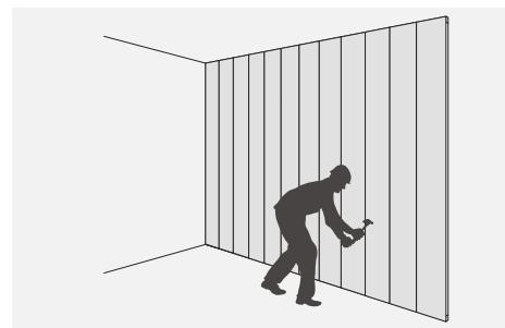
Colocar las demás tablas a mano, con un martillo de caucho o listón de madera. NO golpee el lado macho directamente con el martillo.
