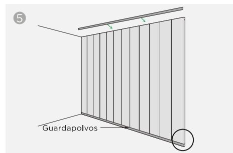
Se recomienda aplicar Molduras Masisa para los encuentros entre cielo y piso, instaladas mediante puntillas y un adhesivo de contacto para asegurar una mejor fijación.
