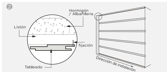
Colocar las tablas de izquierda a derecha. Poner la primera pieza perfectamente aplomada, y atornillar o utilizar adhesivo de montaje en zonas de contacto.
