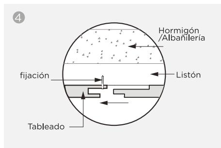
Atornillar la pestaña del lado derecho de los listones horizontales. Los tornillos quedan ocultos al colocar la siguiente pieza.
